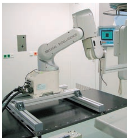
Abb. 2: Testaufbau zur Lageverfolgung eines beweglichen Objekts. Ziel ist es, das Objekt innerhalb des Therapiestrahls zu halten.
