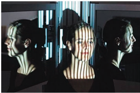
Abb. 2: Stereophotogrammetrie mit dem optischen Sensor FaceScan3D (Fa. 3DShape, Erlangen). Erhebung dreidimensionaler Daten der Gesichtsweichteile.
